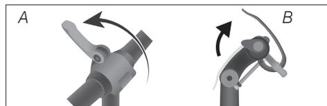
Abb.: Spannhebel am Lenker öffnen
