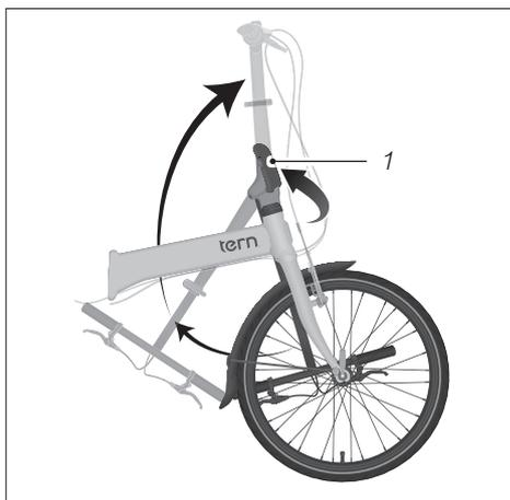
Abb.: Hochklappen des Lenkervorbaus
