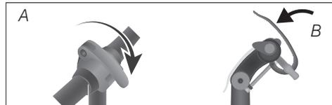
Abb.: Spannhebel am Lenker schließen
