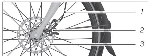
Abb.: Hydraulische Scheibenbremse
